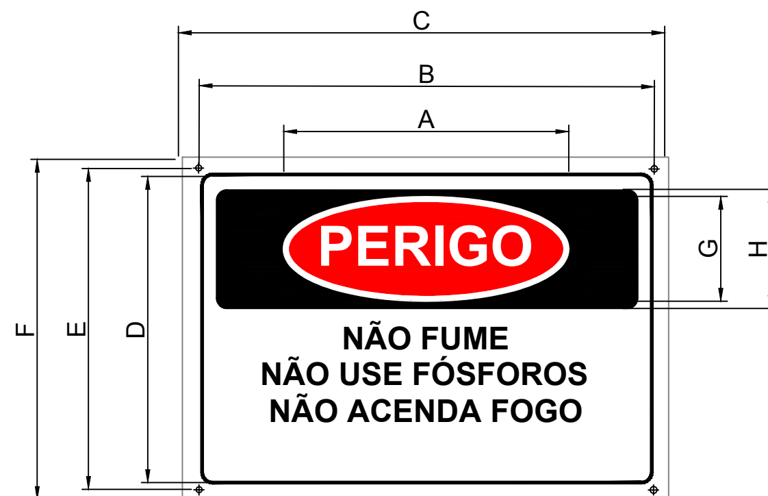
PLACA DE IDENTIFICAÇÃO PLACA DE ADVERTÊNCIA / PERIGO
